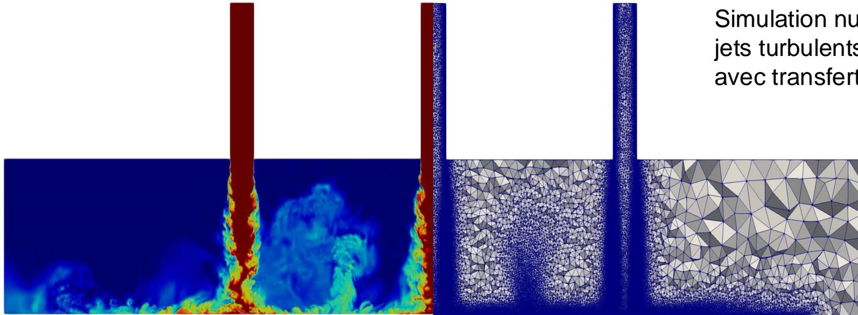
Simulation numérique directe de jets turbulents impactant une paroi avec transferts thermiques
